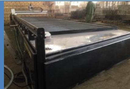
Стол обшит со всех сторон. Имеются специальные люки. В зависимости от комплектации станка подготовка к вентиляции либо отсутствует (бюджетный вариант) или выполнена система вытяжки в зоне реза, что многократно повышает производительность вытяжки. При обустройстве системы вентиляции оборудование должно иметь производительность не менее 6000 м.куб./час.
