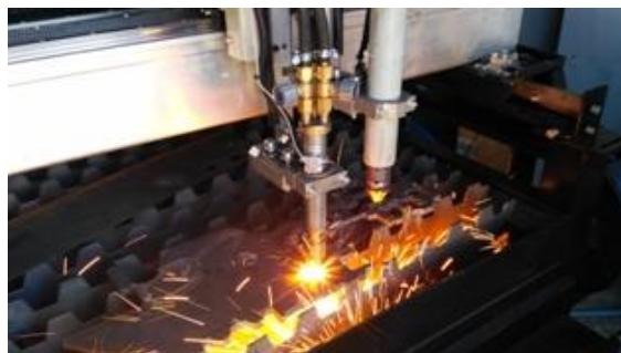
Предназначена для качественного плазменного раскроя листового металла с рабочей зоной 3 м x 1.5 м, толщиной до 0.5 до 100 мм (зависит от источника резки).
