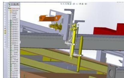
Рабочий стол сухого типа, интегрированный в конструкцию машины. Ширина раскроечного стола 1750 мм, длина стола 3150 мм.
