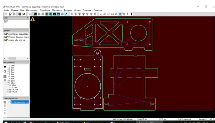
Программа непосредственного управления станком Mach3 специально адаптирована для плазменной резки, изменен так же внешний вид для удобства оператора. Созданы дополнительные функции для экономии расходников резака.
