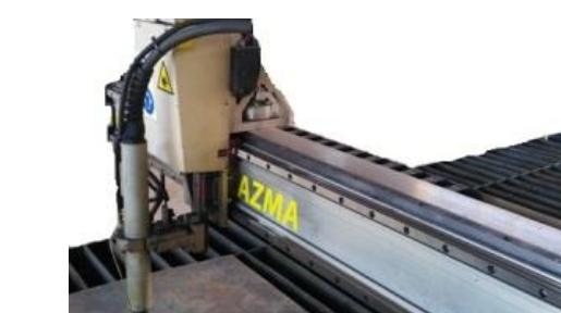
Установлены мощные двигатели с планетарными редукторами и механизмом компенсации люфтов в зубчато-реечной передачи. Все это повышает точность и динамичность работы оборудования и уменьшает время на обслуживание приводов.
