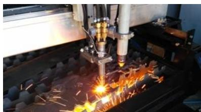
Данную модель возможно дооснastить дополнительным газо-кислородным оборудованием, включающим газовый резак, электронику управления, управляющие клапана, редуктора, огнепреградительные клапаны и т.д..
