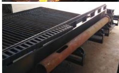
Четвертая дополнительная ось (ось А) для резки круглых труб. Позволяет фигурно, по программе резать трубы диаметром 50-250 мм. Возможность применения: винтовые сваи, фигурные элементы конструкции, элементы соединения трубопроводов и т.д.
